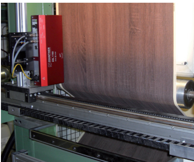
On-line gloss measurement of decor foils / Online-Glanzmessung von Dekorfolien
